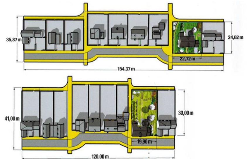
Ci-dessus : illustration schématique d'une économie de voie par une réflexion sur la largeur de parcelle sans impacter le cadre de vie (CAUE 53).
